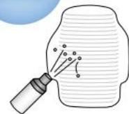
Обработайте поверхность пескоструем (давление 0,2~ 0,25 МПа), используя оксид алюминия 50 мкм. Этот этап рекомендуется проводить при последующем нанесении композитного материала. Незамедлительно после пескоструйной обработки очистите поверхность пароструем или в ультразвуковой ванночке. Затем просушите.
