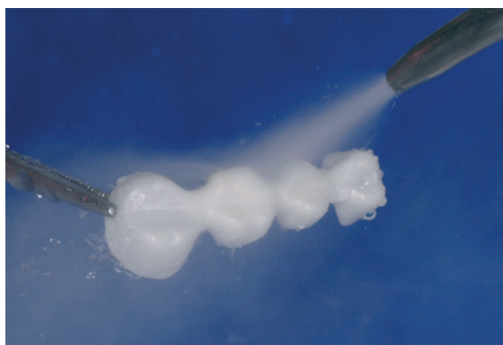
Перед облицовкой промойте каркас в проточной воде или обработайте паром и просушите. Нельзя подвергать каркас пескоструйной обработке частицами Al_2O_3 .
