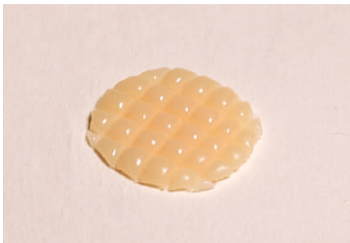
Микрорельеф поверхности неотвержденного композита Реставрин после выдержки при 37 °C в течение 20 мин.
